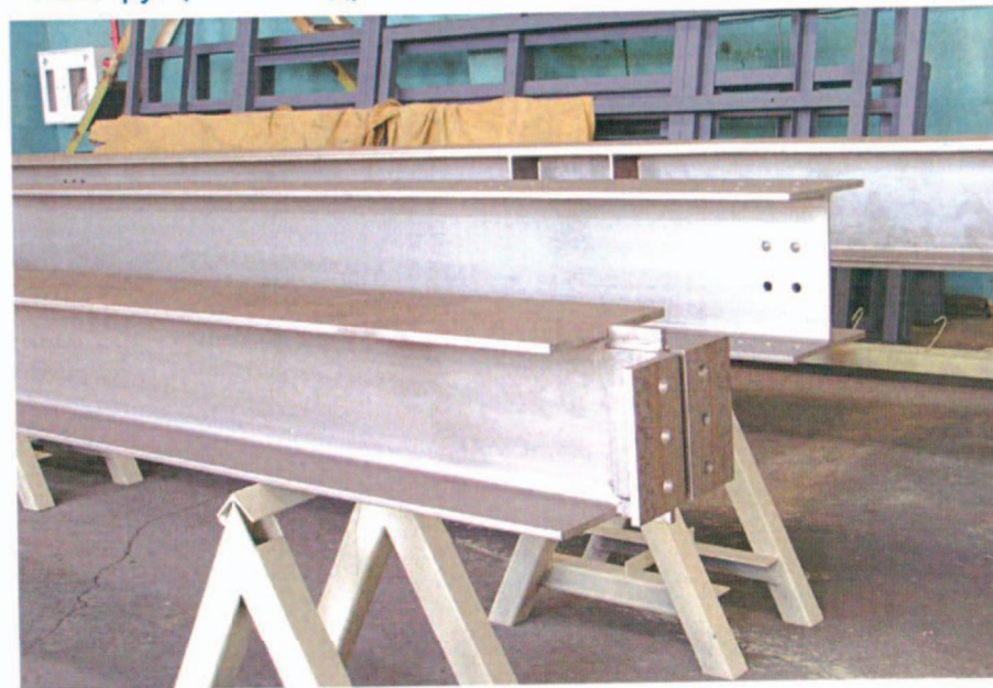
Конструкции после дробеметной очистки (класс очистки Sa-3)
