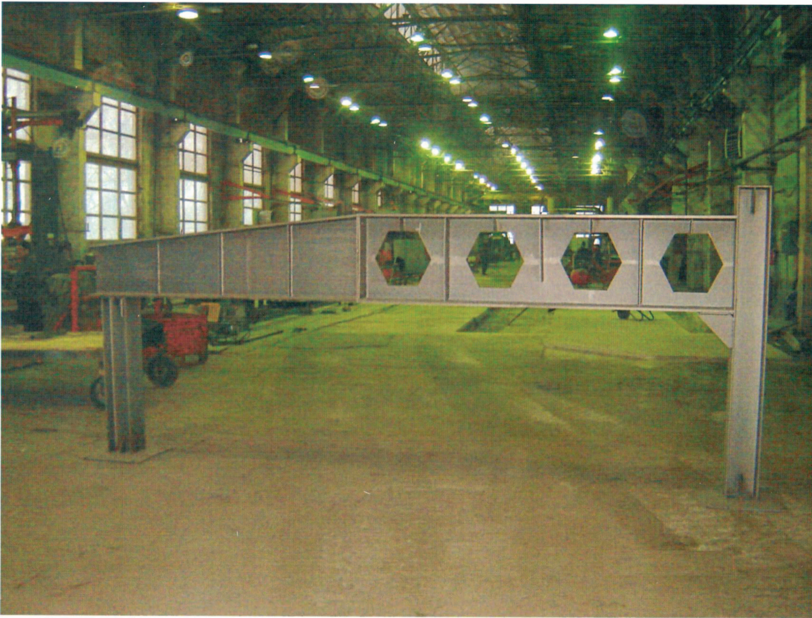
Образцы исполнения двутавровых балок - переменной высоты (слева) и перфорированной (справа)
