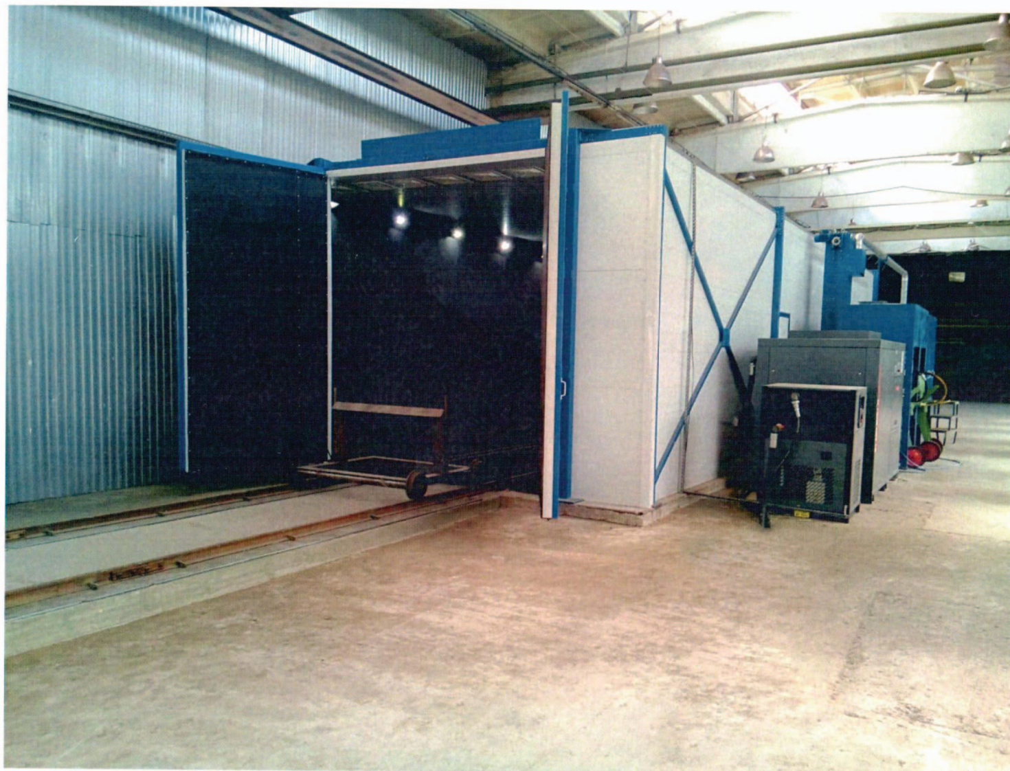
Обитаемая дробеструйная камера (15м x 5м x 3,5м) на два поста
